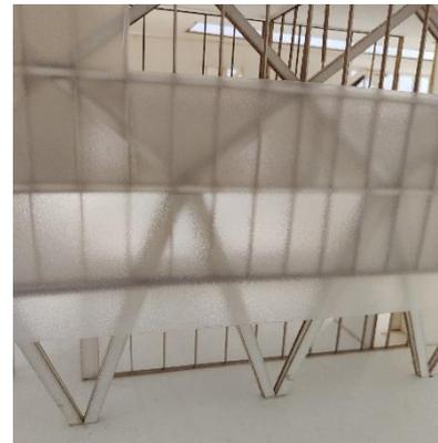
As pequenas amostras permitiram o estudo da entrada de luz em locais pontuais da maquete, tanto com luz natural, como testando lâmpadas dentro da maquete. Assim, foi possível entender a difusão da luz, tanto durante o dia no interior do edifício, como durante a noite sendo a iluminação artificial do edifício a iluminar o exterior de uma forma leve e suave.
