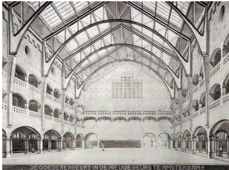
Figura 60 – Edifício Beurs de Berlage (1898-1903), Amesterdão. O uso do tijolo em consonância com a estrutura em aço que suporta a cobertura, permitindo construir um grande vão. Observa-se aqui, a natureza do material transmitida na construção, a ‘verdadeira construção’ proveniente daquilo que é a compreensão do material e o que as suas características permitem construir.
