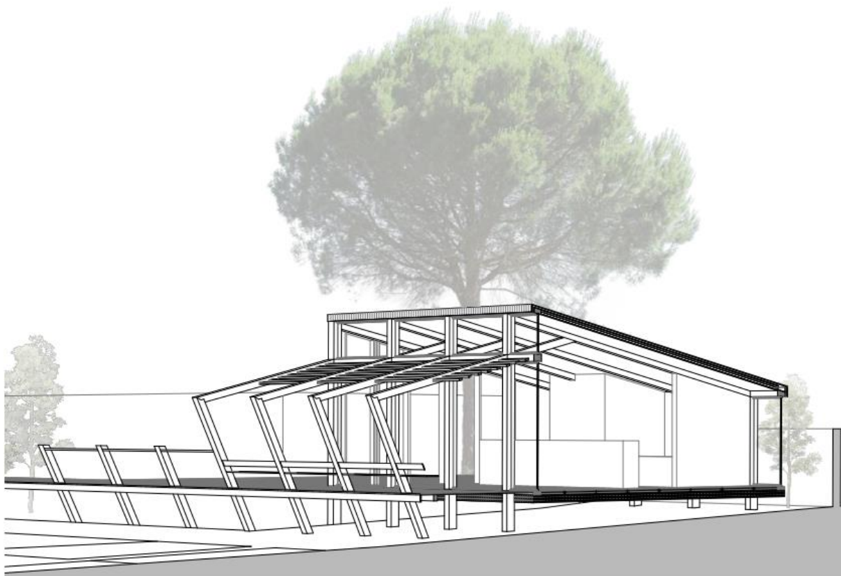
Figura 44 – Corte Perspetivado do Edifício 2 (redução da escala 1/50)
