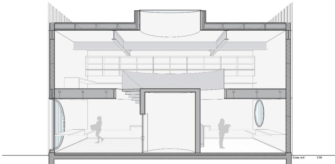
Corte Construtivo Perspetivado | Redução de 1/50
