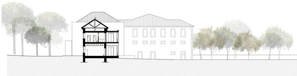
Corte transversal pela zona de quartos e o ginásio (Redução da escala 1:200)
