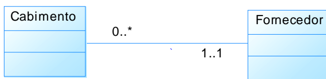
Figura 4.1. Restrição obrigatória entre a classe Cabimento e a classe Fornecedor.
