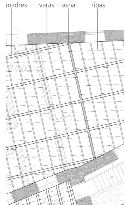
planta de estrutura, parte | escala 1:100
