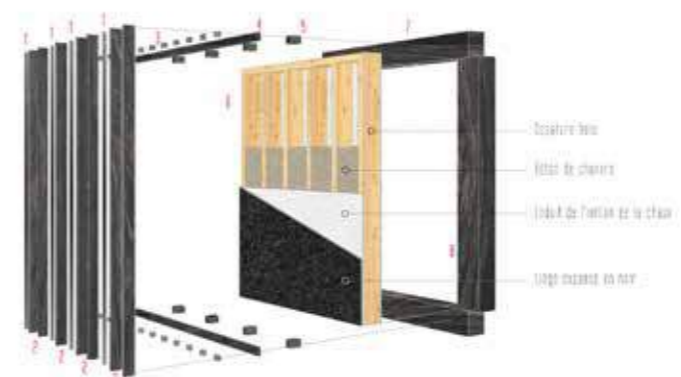
Mur en salle de cinéma
