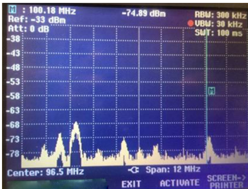
Figura 21 - Modo de funcionamento de um sistema que opera na faixa de 100.18MH
