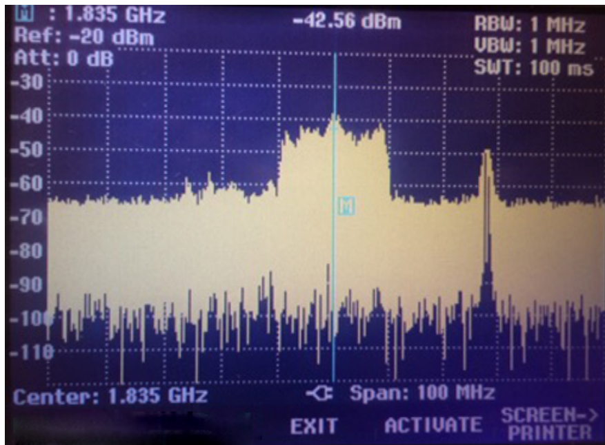
Figura 22 - Modo de funcionamento de um sistema que opera na faixa de 1.835GHz
