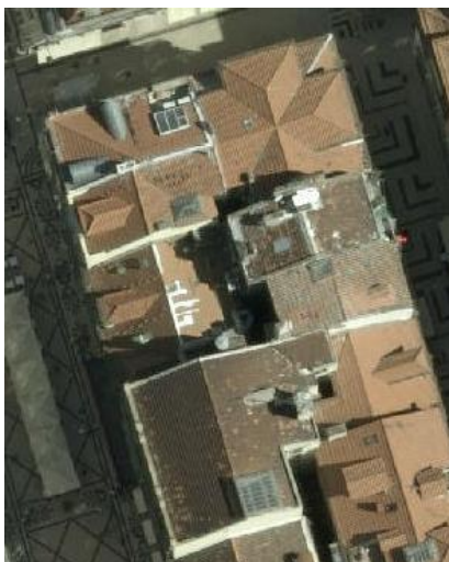
Fig. 54 - Vista aérea do saguão no quarteirão 48.001.11, onde se vê a ocupação do saguão pela junção das paredes posteriores de edifícios pertencentes aos mesmos proprietários. 172
