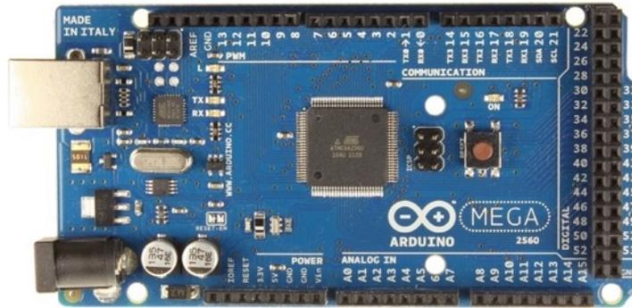
Figura 4.3 – Plataforma de desenvolvimento *Arduino Mega*.
