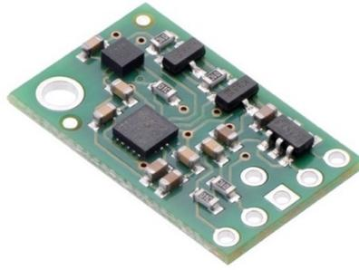
Figura 4.4 – Sensor *IMU* utilizado (*Pololu MinIMU-9 v3*).
