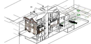
Figura 29 - Sobreposição da nuvem de pontos com o modelo Revit (Crédito Fotográfico FVPS, 2013)
