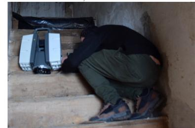
Figura 39 - Transporte do equipamento para o sótão – a estação teve de ser retirada do tripé para facilitar a passagem (fotografia da autora novembro 2017)
