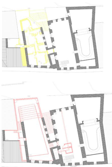
Figura 21 - Exemplo de demolição e planta proposta para o piso 2. Planta à cota 77.70m
