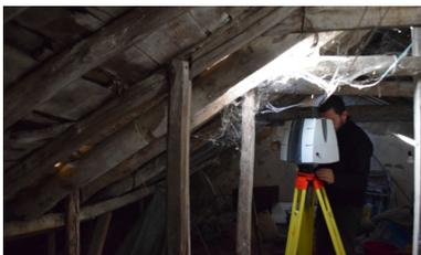
*Figura 35 - Colocação do equipamento no local para recolha, no momento o técnico encontrava-se a recalibrar o mesmo (fotografia da autora novembro 2017)*
