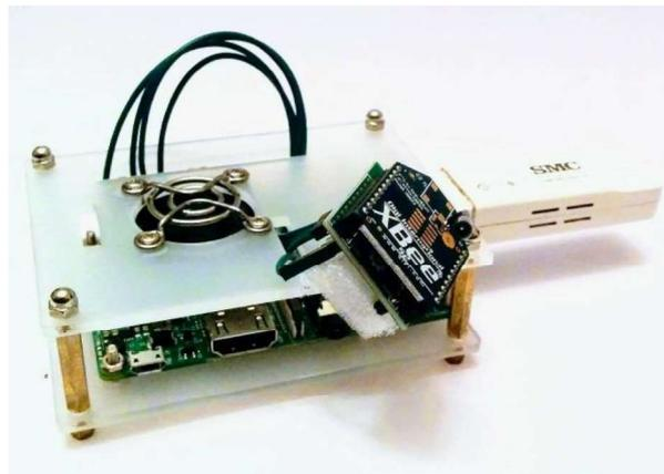
**Figura 3.17: Protótipo da *gateway* incluindo XBee, ligação Wi-Fi e Raspberry.**
