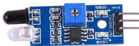
**Figura 3.4: Sensor de proximidade por radiação infravermelha.**
