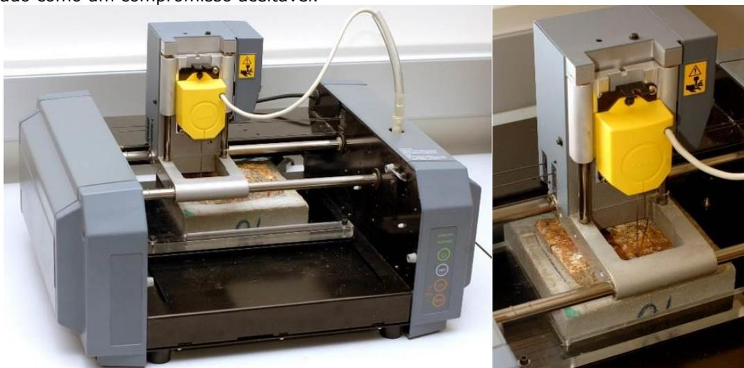
Figura 1 - Equipamento de digitalização Roland MDX-20 em operação.
