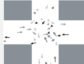
Figura 4 - Representação da auto-organização do tráfego em cruzamentos, onde os agentes representados por vetores de deslocação e cor de grupo, a formam uma rotunda instável, com atravessamentos verticais e horizontais pontualmente. [31]
