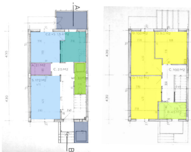
Imagem 35| Planta da tipologia T3 duplex dos blocos habitacionais da Caselcoop da segunda fase de construção.
