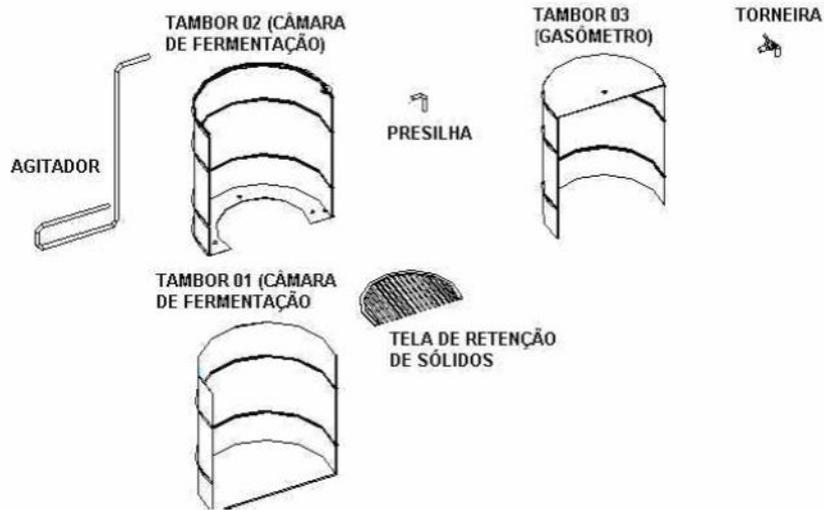
Vista em corte do Biodigestor e seus componentes
