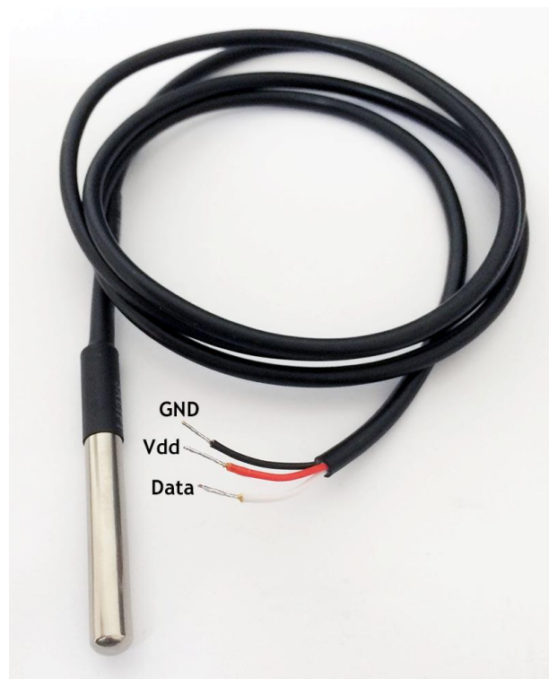
Figura 8. Sensor de temperatura- DS18B20
