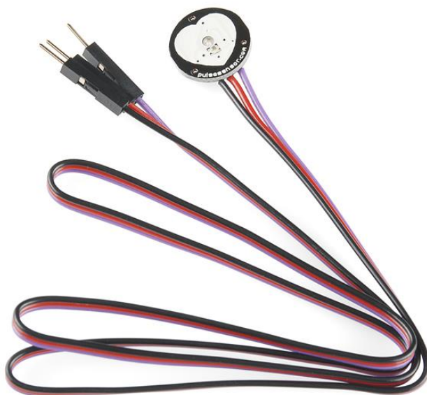
Figura 11. Sensor de ritmo cardíaco- Pulse Sensor
