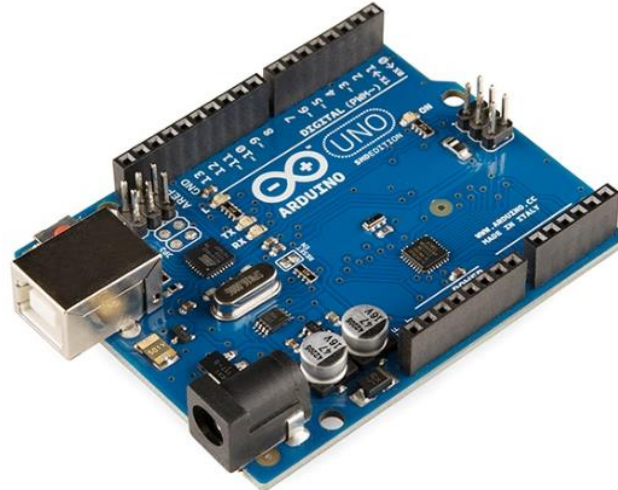
Figura 2. Microcontrolador- Arduino Uno
