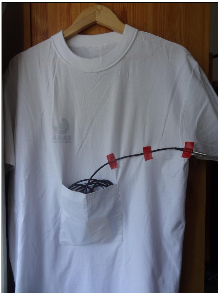
Figura 51a. Colocação do sensor de temperatura na t-shirt de testes
