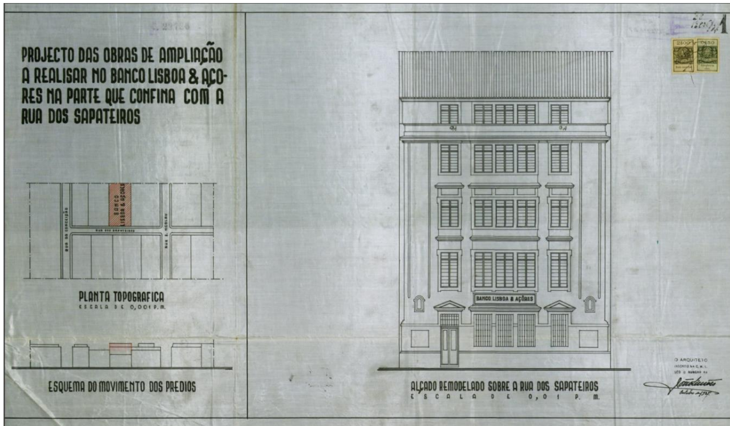
Imagem 48- Projeto das obras de ampliação do Banco Lisboa & Açores, na parte que confina com a Rua dos Sapateiros, in AML.
