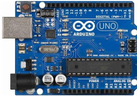
FIGURA 4 - PLACA ELETRÔNICA ARDUÍNO UNO
