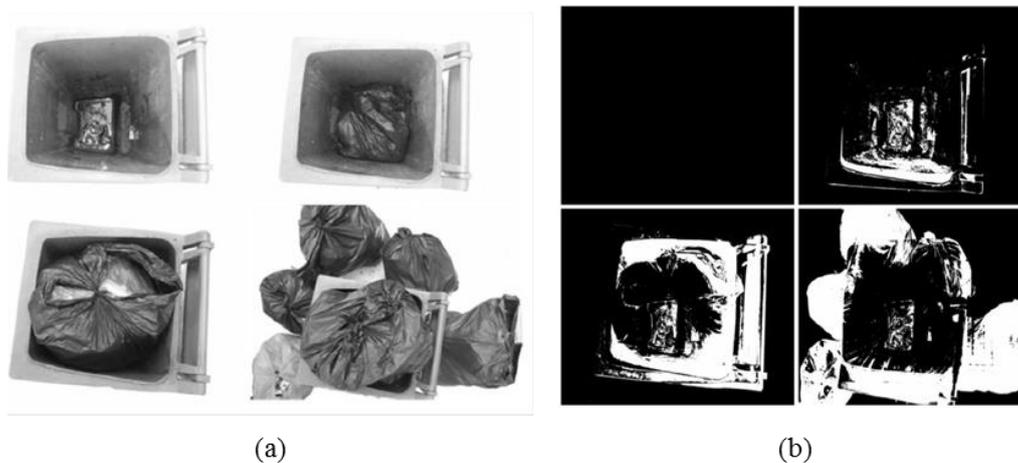
Figura 2.5 – Utilização de sensores de imagem para monitorização de enchimento de contentores: (a) imagem real; (b) imagem binária. Adaptado de Arebey, Hannan e Basri (2011).
