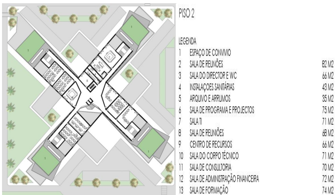
Figura 12 - Planta do piso 2 e suas respectivas dimensões
