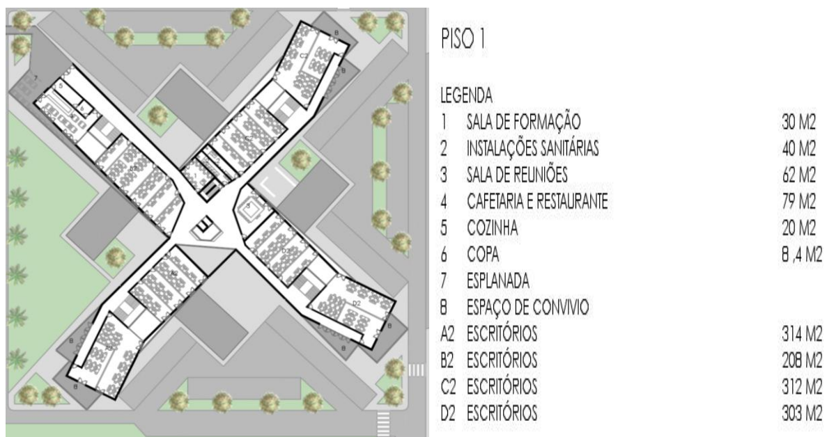
Figura 10 - Planta do piso 1 e suas respectivas dimensões
