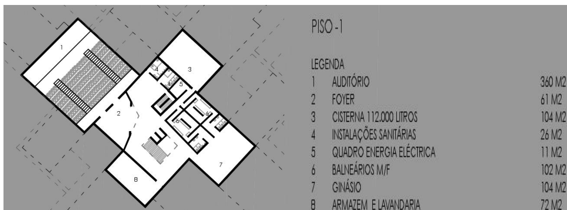
Figura 6 - Planta do piso -1 e as respetivas dimensões
