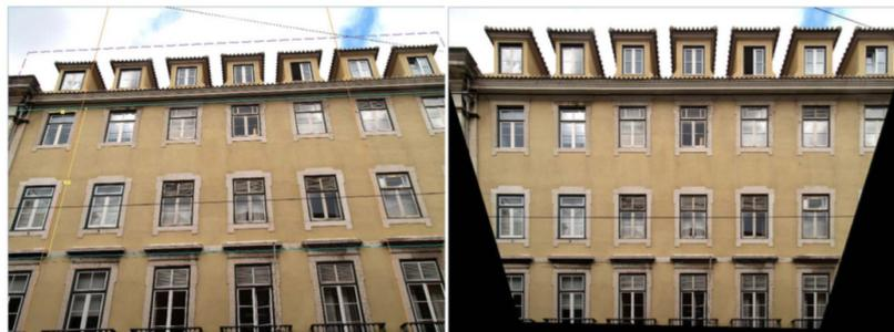
A estereofotogrametria é uma técnica que se baseia na utilização de duas imagens fotográficas de um mesmo objeto (par estereoscópico) (ilustração 9a). Na captação das fotografias, os eixos óticos das câmaras têm de estar paralelos entre si e as imagens obtidas com a mesma direção e distância ao objeto. Permite a visão estereoscópica e a restituição fotogramétrica. Em cada imagem fotográfica são identificados os pontos homólogos.
