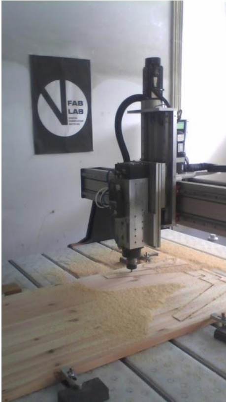
Fig.127- Processo de fresagem na CNC (máquina de corte por métodos digitais)
