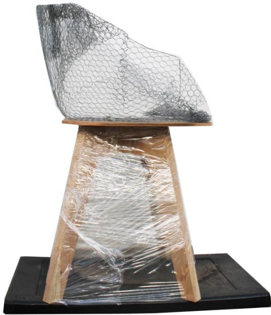
Fig.132-Molde em rede antes do enchimento
