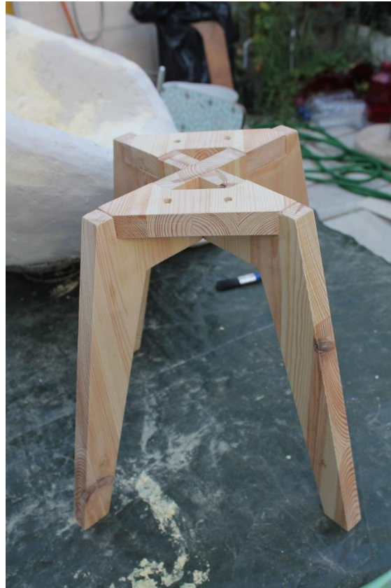
Fig.128- Estrutura das pernas concluída
