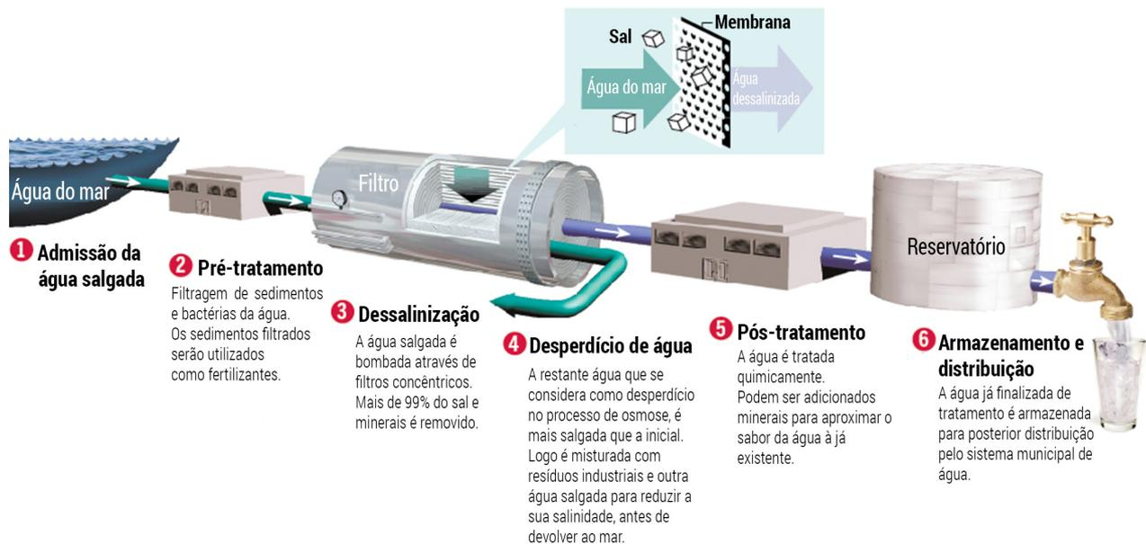
Fig. 3.6 - Esquema genérico do processo de dessalinização por osmose invertida
