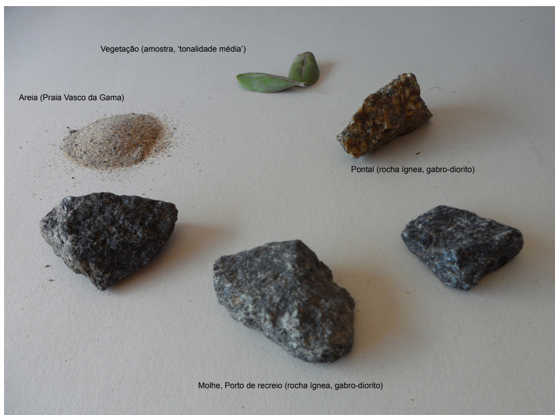
Fig. 132 - Amostras físicas (elementos permanentes) recolhidas no local de intervenção : Areia (Praia Vasco da Gama): S 4020-Y20R Rocha-Pontal (rocha ígnea, gabro-diorito): S6030-Y30R, S4040-Y20R, S4030-Y30R, S3020-Y10R Rocha-Molhe (rocha ígnea, gabro-diorito): S6502-Y, S2002-Y (branco) Vegetação: S5030-G50Y.
