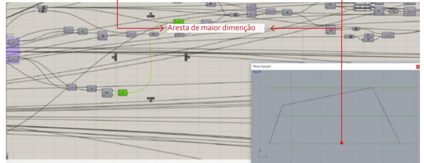
Fig. 51\_ Rotação da Base orientando a Aresta de maior dimensão com o eixo x. Divisão dos pórticos.
