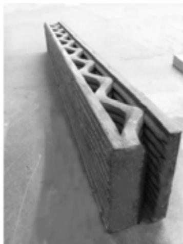
Fig. 14\_ Contour Crafting, Protótipo de parede, (Koshnevis, 2006)
