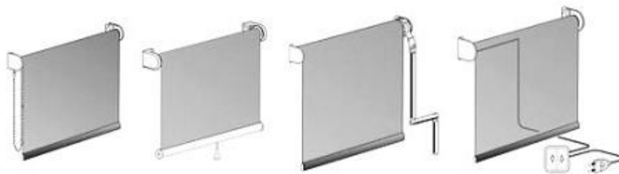
Ilustração 22 - Exemplo de sistema de tela de rolo: Corrente, Mola, Manivela e Motorizado. Controsol
