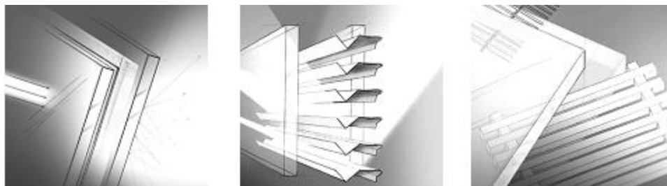
Ilustração 25 - Esquemas de inter-camadas em vidros duplos, Okalux
