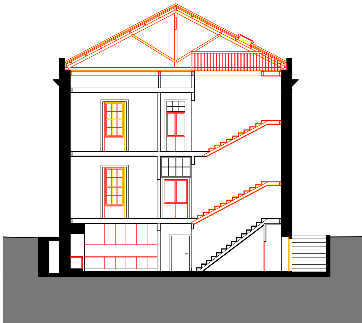
Corte DD' - Demolição/Construção
