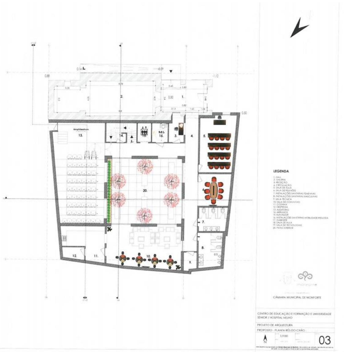
Figura 2 – Planta de arquitectura, rés de chão do Edifício para a Universidade Sénior de Monforte
