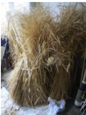
Figura 22 - Material (palha de centeio) utilizado na construção das coberturas em colmo, tal como saído da malhada junto em molhos de palha (foto trabalho da autora).
