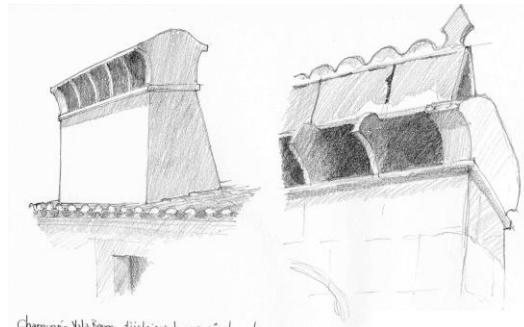
Topo de chaminé - Vila Boim - com a degradação e queda das argamassas de revestimento mostram-se os diversos elementos estruturais cerâmicos.
