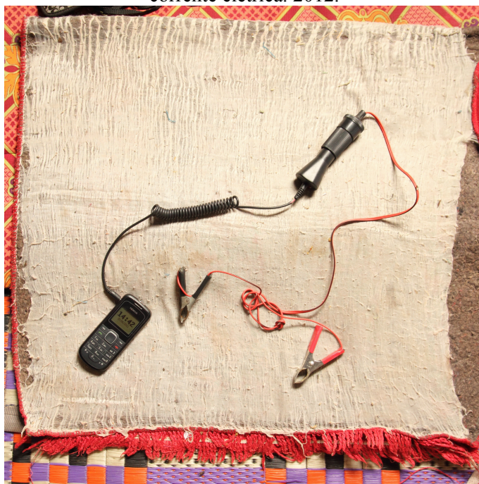
2. Sistema de carregamento alternativo para bateria de automóvel. Aldeia de Foss. 2011.
