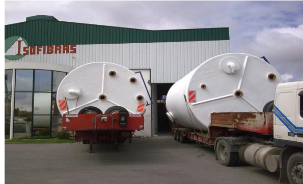
Foto 2: Decantadores com 4m diâmetro e 8,5m altura
