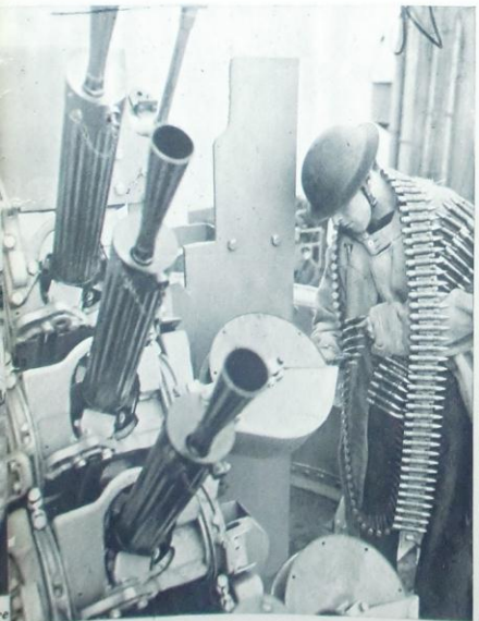
A defesa dos navios ingleses contra os aviões inimigos. Uma metralhadora quadrupla, anti-aérea, está sendo carregada. As quatro bocas de fogo despejam milhares de balas por minuto
